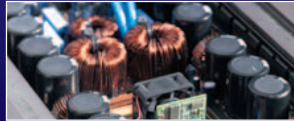
Muss sein: Das Drossel-Trio wird von einem eigenen Lüfter gekühlt.
